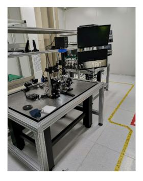
硅光芯片耦合测试系统的应用技术领域,公开了光子集成芯片的新型测试系统及方法,包括测试设备和集成芯片放置设备,测试设备包括电耦合测试设备和光耦合测试设备中的一种或两种,电耦合测试设备和光耦合测试设备可拆卸安装在集成芯片放置机构四周,电耦合测试设备包括单探针耦合模块和探针卡耦合模块,光耦合测试设备包括阵列光纤耦合模块和光纤耦合模块;该通过改进结构,形成电耦合测试机构和光耦合测试设备,通过搭配组装可灵活对待测试集成芯片进行光耦合测试和电耦合测试,安装方便快捷,成本低。
